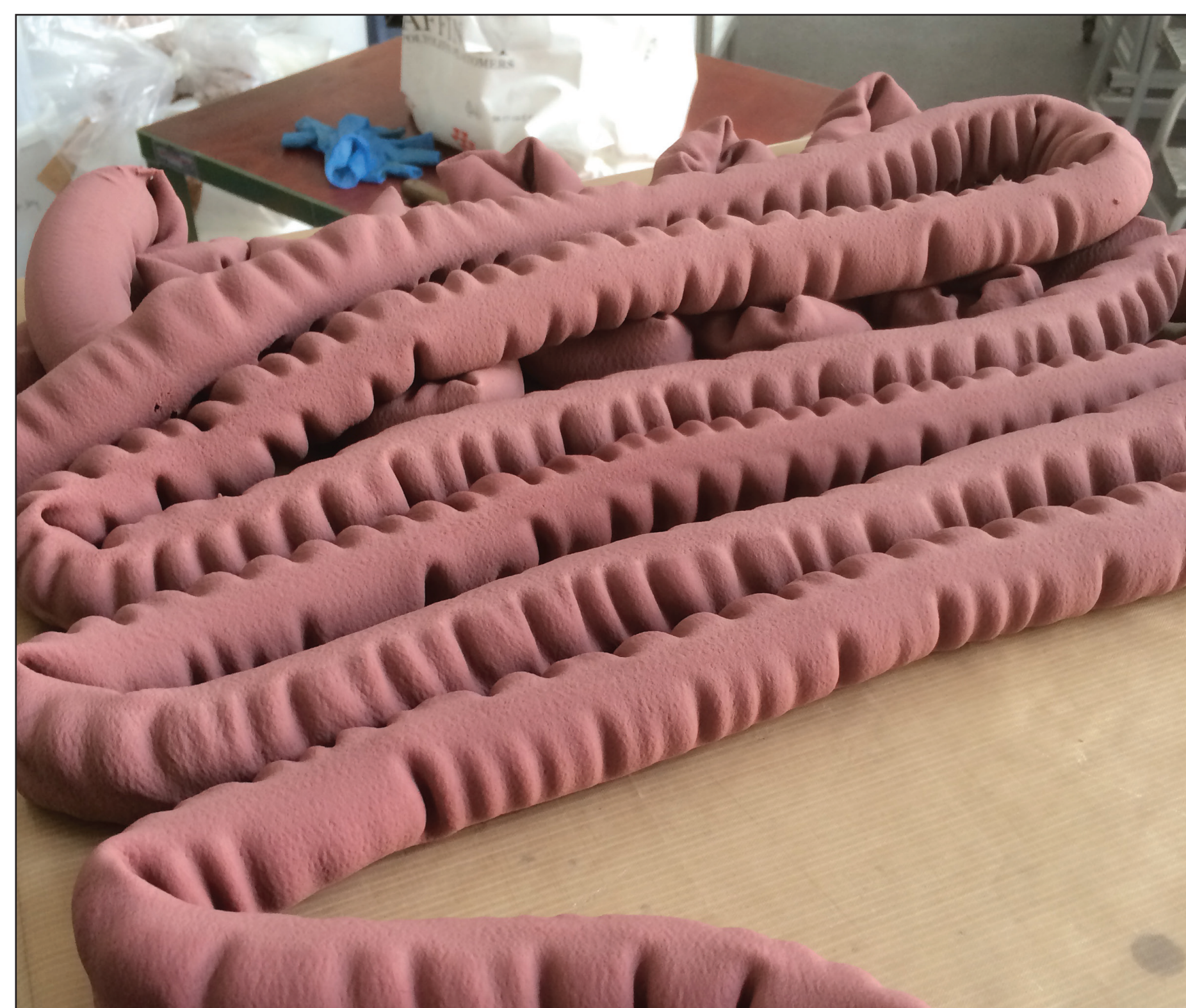
Abb. 1: Darmmodell aus thermoplastischem Kollagen als Endlosware
